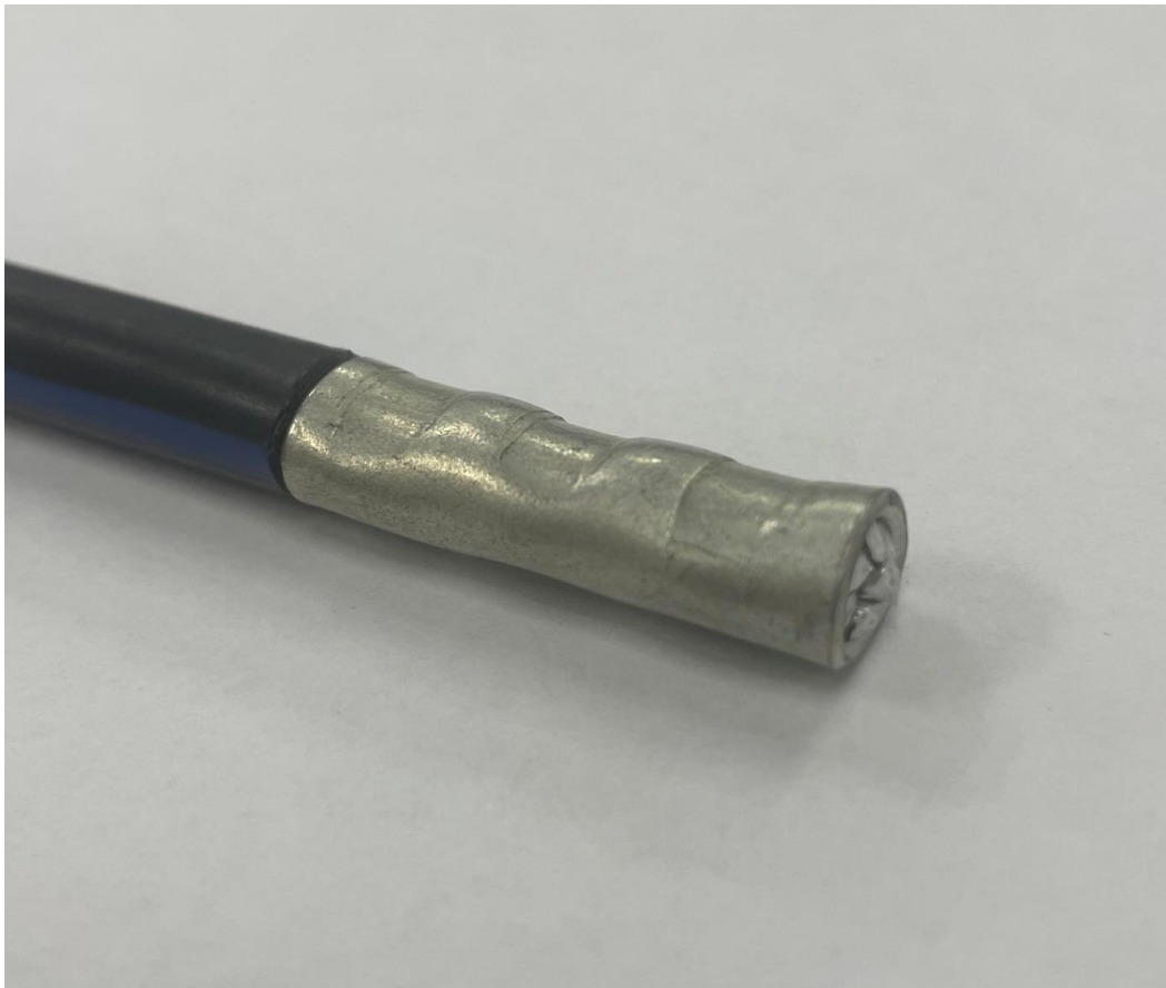
Рисунок 21 - Пример обжатия многожильного провода
