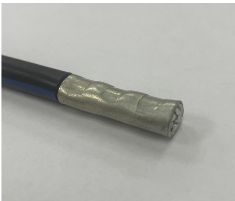
Рисунок А.4 – Пример обжатия многожильного провода типа СИП
